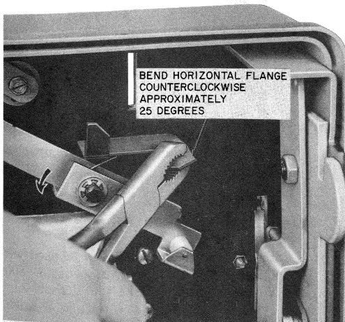
Fig. 61—Bending Chute Guide (Limit Stop)
